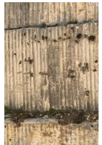
Historische Abbaumethode mittels Bohrungen
